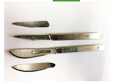
図：開発した高強度チタン合金を用いて試作したメスの刃先（最上段と最下段）。中央の2つは市販品。
