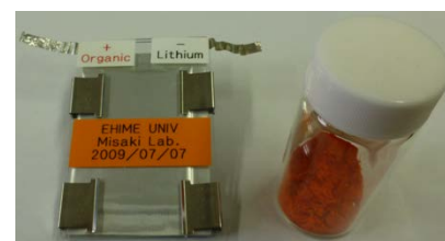
図：有機材料を正極活物質として用いた試作電池と活物質分子の試料
