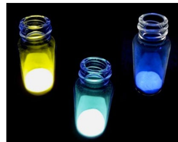
図：開発したレアアースフリー蛍光体(紫外線照射により可視光線を発
