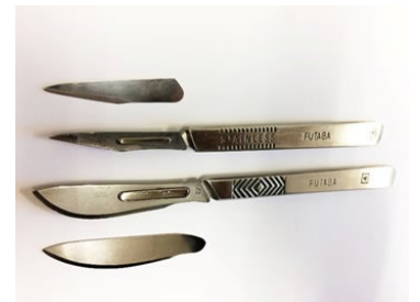
図：開発した高強度チタン合金を用いて試作したメスの刃先（最上段と最下段）。中央の2つは市販品。
